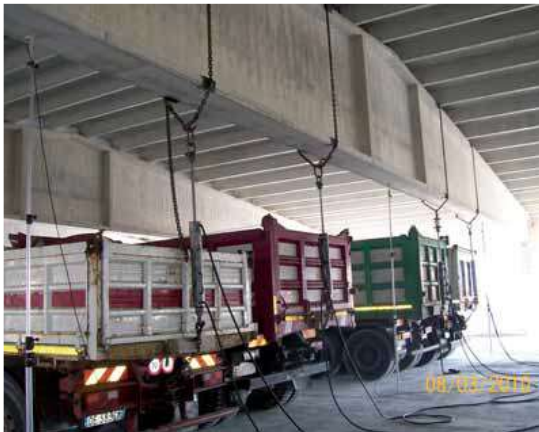
applicazione di quattro forze ai nodi della capriata
